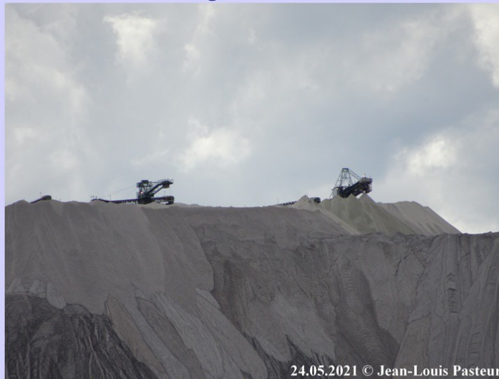
La tête de la machinerie qui monte le sel rejeté au sommet
